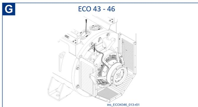
G. Убедитесь, что устройство PMG3 точно установлено в корпусе. Для этого убедитесь, что вращающиеся детали поворачиваются свободно без каких-либо помех, затем проведите провода, как показано на рисунке, и подключите их к регулятору в соответствии со схемой.
