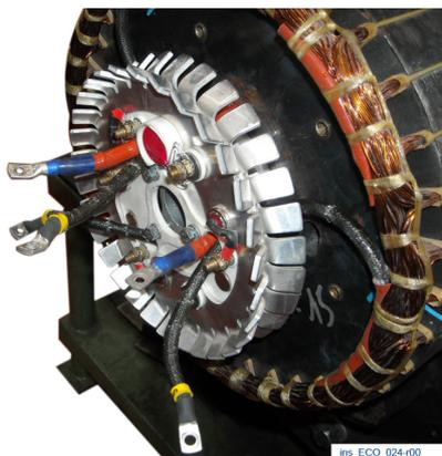
Вставьте вращающийся диодный мост и закрутите 3 винта М5 с моментом 3,3 Н·м.
