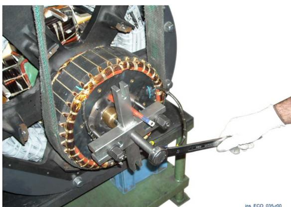
Закрепите статор возбuditеля на подходящем подъемном устройстве с помощью мягкого ремня. Снимите его с помощью соответствующего съемника Mecc Alte.
