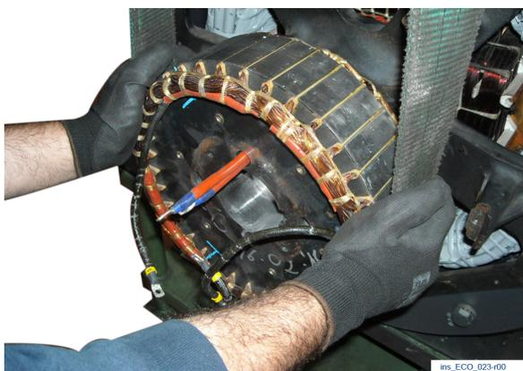
С помощью соответствующей подъемной системы и мягкого ремня поднимите ротор возбuditеля.
