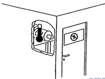
**i** Устанавливайте генератор в хорошо проветриваемом помещении. Недостаточная вентиляция может привести к перегреву и неисправностям генератора.
