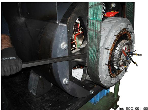
Снимите крышку клеммной коробки и относящиеся к ней панели, отсоедините цифровой регулятор, затем снимите заднюю защелку и задний картер.
