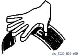
Halten Sie das Netz während der Montage und Demontage mit beiden Händen fest, um zu verhindern, dass das elastische Material den Bediener oder einen Nahestehenden trifft.
