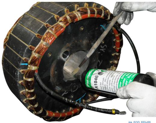
Reinigen Sie das Loch des Erreger-Rotors. Entfernen Sie Schmutz und restlichen Klebstoff.
