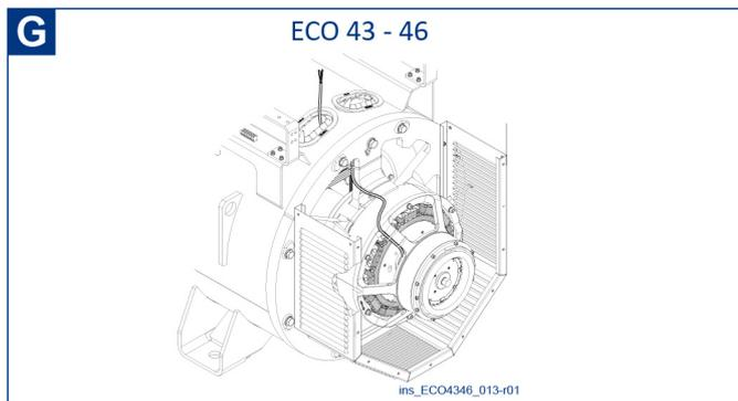
G. Stellen Sie sicher, dass sich das PMG3 an optimaler Stelle im Gehäuse befindet, indem Sie prüfen, ob sich die drehbaren Teile ohne Hindernisse drehen lassen, führen Sie dann die Kabel wie in der Abbildung gezeigt entlang und schließen Sie sie gemäß des Schaltplans am Regler an.
