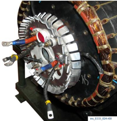
Führen Sie die drehbare Diodenbrücke ein und schrauben Sie die 3 M5-Schrauben mit 3,3 Nm an.
