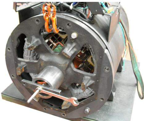
Heben Sie die hintere Abdeckung mit einem geeigneten Hebezeug an und bringen Sie sie in Position. Schrauben Sie eine Gewindestange in das Loch an der Welle. Schrauben Sie eine Mutter auf die Gewindestange. Führen Sie zwischen die Mutter und die hintere Abdeckung ein zylindrisches Zwischenteil ein, das von einer geeigneten Scheibe überschritten wird. Schrauben Sie die Mutter an, um das Lager in das Gehäuse der hinteren Abdeckung einzuführen.
