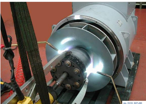
Erwärmen Sie die Drehhalternabe. Verwenden Sie zwei autogene Anwärm Brenner. Üben Sie Druck auf die Abziehvorrichtung aus, bis die Nabe vollständig entfernt wurde.
