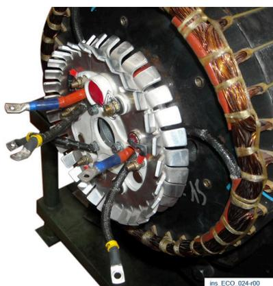
Insertar el puente de diodos rotativo y atornillar los 3 tornillos M5 a 3,3 Nm.
