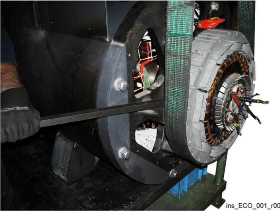
Retirar la tapa de la caja de bornes y sus paneles, desconectar el regulador digital, y quitar la parte posterior y el cierre posterior de la carcasa.
