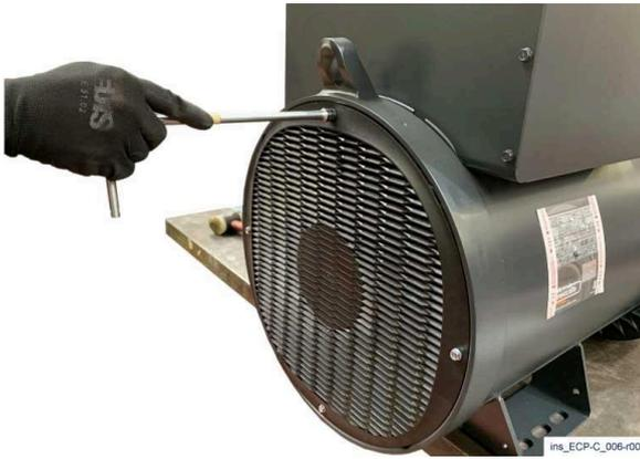
1) Retire la cubierta de la caja de terminales y la parrilla trasera.
