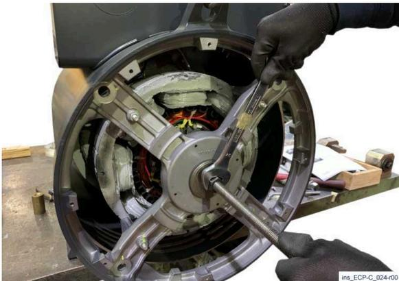
7) Atornille una varilla roscada en el orificio trasero del eje y atornille una tuerca en el otro extremo, interponiendo una brida de dimensiones adecuadas entre la tuerca y la cubierta posterior. Luego apriete la tuerca hasta que el rodamiento del eje haga contacto contra su asiento en la cubierta posterior.
