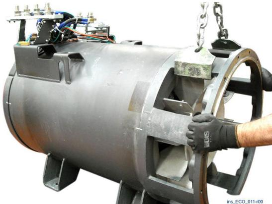
Enganchar la tapa anterior a un dispositivo de elevación. Golpear con un martillo de goma para retirar de la carcasa.
