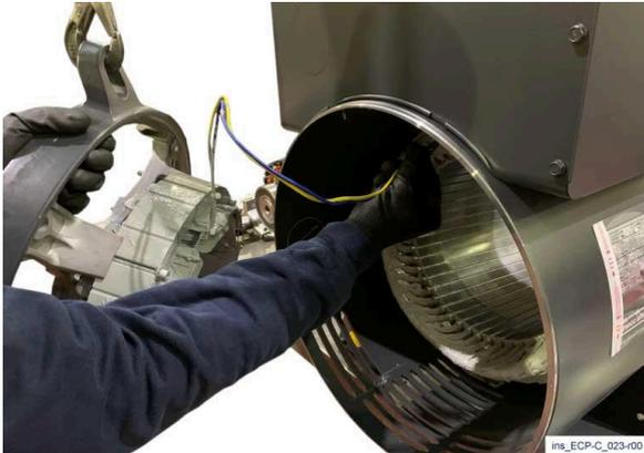
6) Enganche la cubierta posterior a un dispositivo de elevación adecuado, vuelva a insertar los cables amarillo y azul en el orificio del prensaestopas apropiado, luego inserte la cubierta posterior en el asiento.
