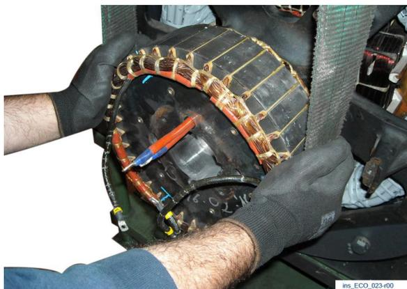
Con un sistema de elevación adecuado y con la ayuda de una correa suave, levantar el rotor excitatriz.
