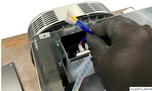
2) Corte las bridas de los cables del regulador, luego retire los cables amarillo y azul. Deslice estos cables a través del orificio del cable.
