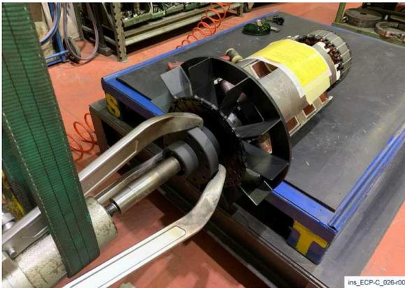
1) Instale un extractor hidráulico especial en el cubo. Ponga el extractor bajo presión.
