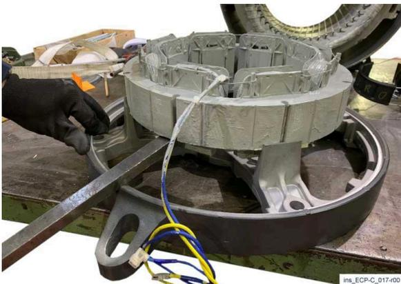
11) Usando una palanca apropiada, retire el estator del excitador.
