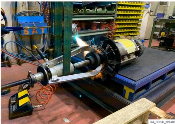
2) Caliente el cubo del soporte del disco con una antorcha de oxiacetileno, manteniendo el extractor bajo presión, hasta que el cubo se extraiga por completo.
