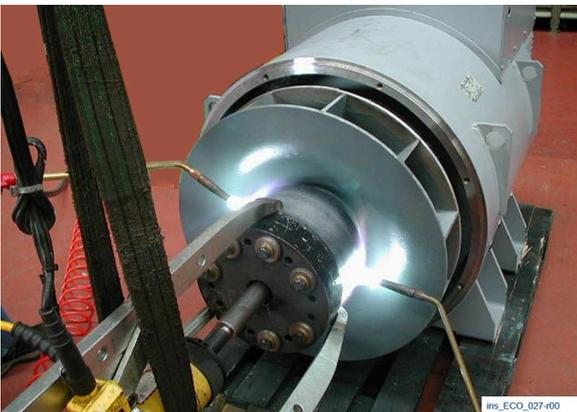
Erwärmen Sie die Drehhalternabe. Verwenden Sie zwei autogene Anwärmebrenner. Üben Sie Druck auf die Abziehvorrichtung aus, bis die Nabe vollständig entfernt wurde.
