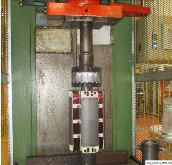
2) Setzen Sie mit dem Druck einen neuen Erregerrotor auf die Welle. Alternativ ist es möglich, es auf 110 ° C zu erwärmen und bis zur Wellenstreifen zu drücken. Ziehen Sie die Hauptrotordrähte durch das Erregerrotorloch und fixieren Sie sie mit der richtigen Polarität in der Diodenbrücke.
