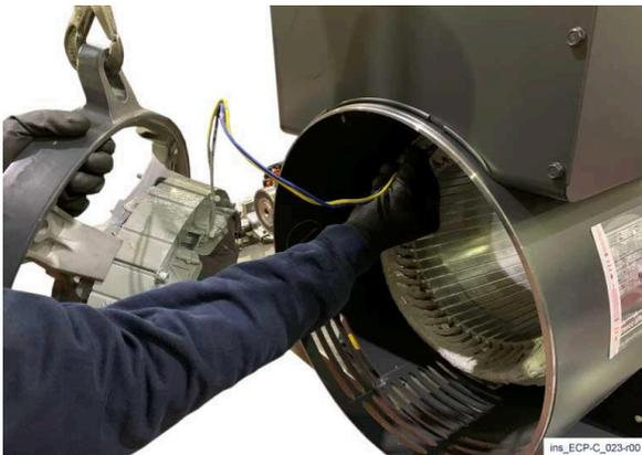
6) Binden Sie die Nichtantriebs-Endhalterung mit einem geeigneten Hebesystem ein, setzen Sie die gelben und blauen Drähte wieder durch das entsprechende Loch im Rahmen ein, und setzen Sie dann die Nichtantriebs-Endhalterung an ihrer Stelle ein.
