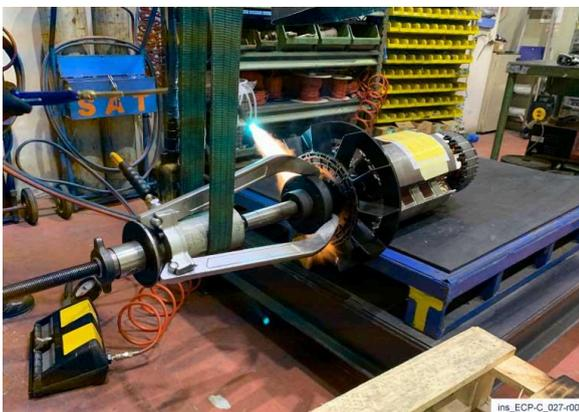
Erwärmen Sie die Nabe mit einem Autogenbrenner und ziehen Sie den Extraktor kontinuierlich bis zur vollständigen Entnahme der Nabe.
