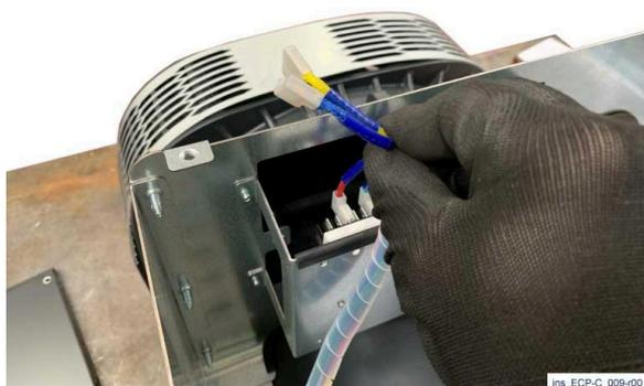
2) Schneiden Sie den Kabelbinder der Reglerdrähte ab, entfernen Sie das gelbe und blaue Kabel vom Regler und ziehen Sie es durch seine Öffnung im Rahmen.
