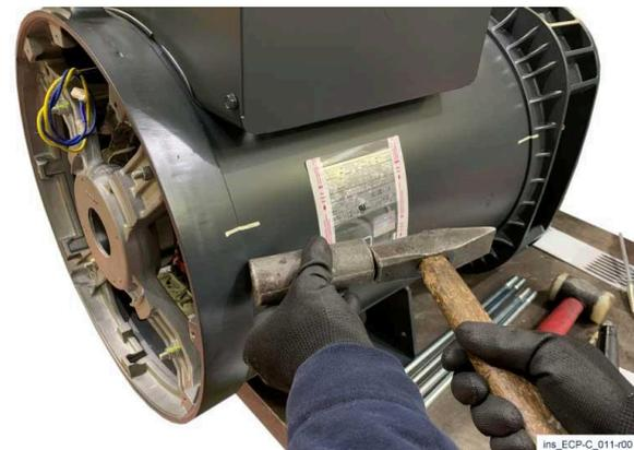
6) Entfernen Sie das N.D.E. mit einem Hammer und einem Aluminium- oder Kupferstange.
