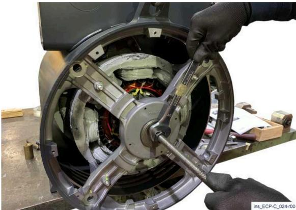
7) Schrauben Sie eine Gewindestange in die Gewindebohrung der Welle, und schrauben Sie eine Mutter hinein, wobei Sie einen Ausgleichsflansch zwischen der Mutter und der nicht antriebsseitigen Halterung anbringen. Schrauben Sie die Mutter auf, bis das Lager den N.D.E erreicht. Halterung Streifen.
