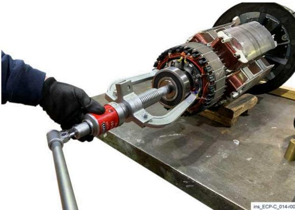
9) Entfernen Sie das Lager mit einem geeigneten Auszieher von der Welle. Entfernen Sie den Erregerrotor mit einem Abzieher.
