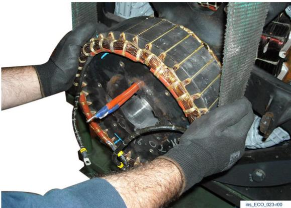
Heben Sie den Erreger-Rotor mit einem geeigneten Hebezeug und einem weichen Gurt an.
