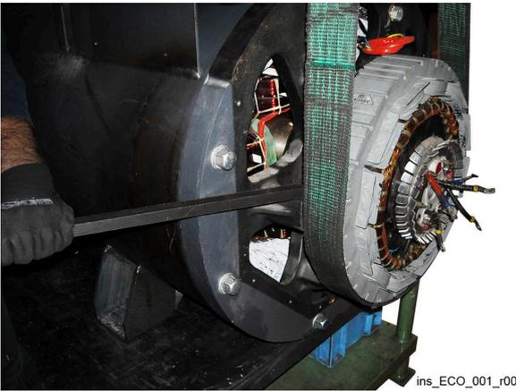
Entfernen Sie die hintere Abdeckung des Klemmenkastens und der dazugehörigen Platten, trennen Sie den digitalen Regler, entfernen Sie dann die hintere Abdeckung und dessen Seitenbleche.
