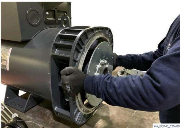
8) Setzen Sie die Halterung am Antriebsende entsprechend den zuvor gemachten Zeichen ein, und setzen Sie dann die Schrauben für die Abdeckstreben ein. Verbinden Sie schließlich das blaue und gelbe Kabel am Regler in derselben vorherigen Position und fixieren Sie es mit einem Kabelbinder. Befestigen Sie dann das hintere Gitter und die Abdeckung des Klemmenkastens.
