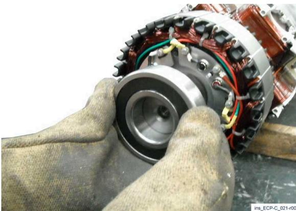
4) Setzen Sie das Lager mit geeigneten Anti-Verbrühungshandschuhen bis zur Wellenstreifen ein.
