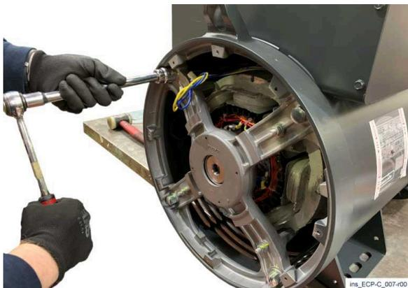
3) Entfernen Sie die Schraube die Abdeckung.
