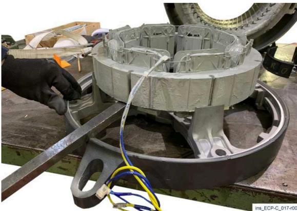
12) Entfernen Sie den Erregerstator mit einem Hebel.
