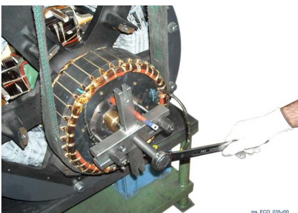
Assicurare il rotore eccitatore ad un adeguato dispositivo di sollevamento utilizzando una cinghia morbida.
