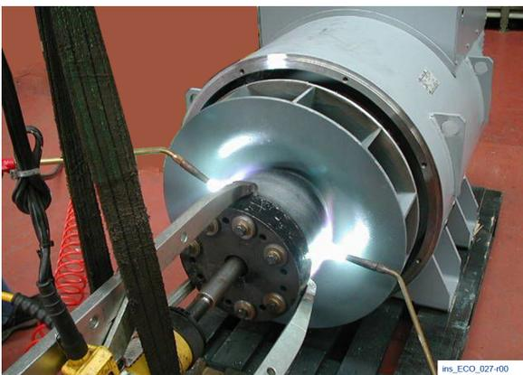
Scaldare il mozzo portadischi. Utilizzare due cannelli ossiacetilenici.
